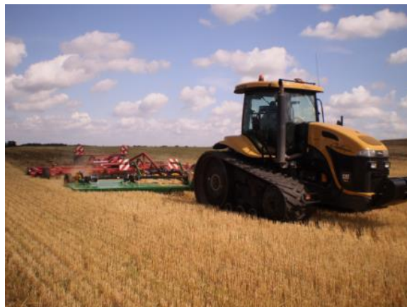
Figur 6.4: Green-Tec har udviklet beslag, så der på deres rotorsnittere på op til 7,3 m arbejdsbredde kan eftermonteres en harve. Foto: John Christensen, Green-Tec
