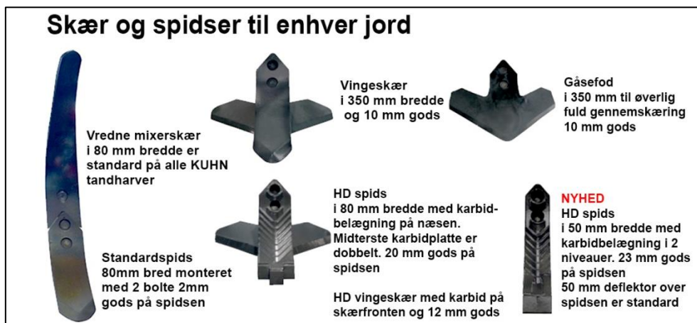
Figur 6.11: Eksempel på forskellige tandtyper. Foto: MI
