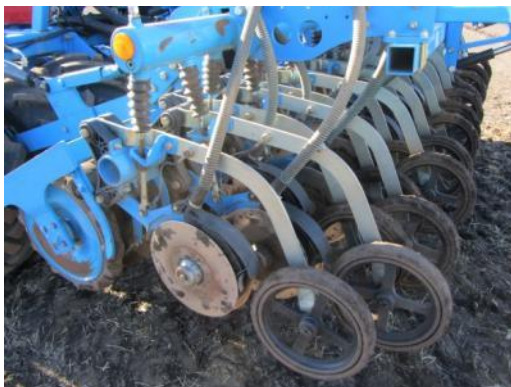
Figur 6.18: Skiveskær på Lemken Solitair. Dybdestyringshjulet er monteret efter skiveskæret. Foto: Henning Sjørsløv Lyngvig
