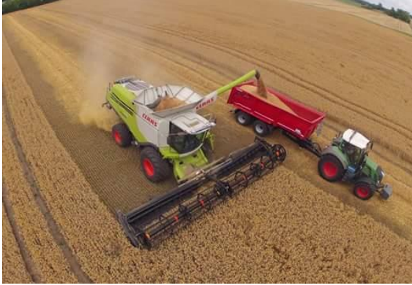
Figur 6.1: Der kan være udfordringer med spredningen af halmer ved store skærebordsbredder, derfor er det vigtigt med korrekt indstilling af halmknitter og avnespreder, dette gælder uanset mærke. Foto: Stroco Agro.
