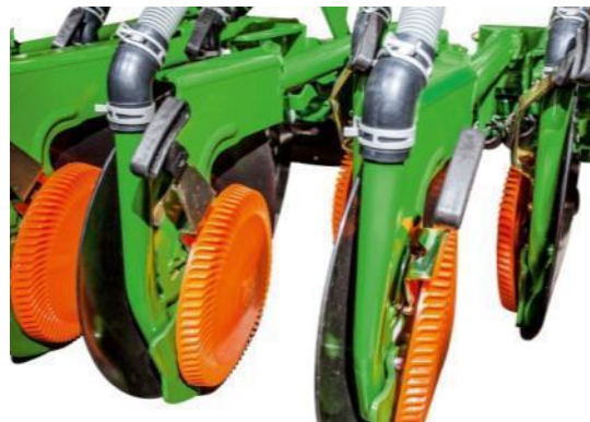
Figur 6.19: Skiveskær på Amazone Cirrus. Dybdestyringshjulet er monteret på siden af skiveskæret. Foto: Amazone
